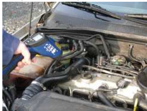
Misurando la temperatura nel motore di una macchina col termometro infrarosso.
