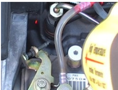
Misura la temperatura nel motore di una macchina col termometro infrarosso.
