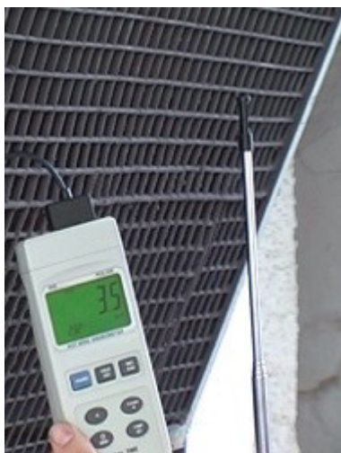
Termooanemometro 009 mentre realizza una misura in una uscita di un estrattore di fumo.
