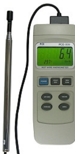
Termoanemometro con software (le colonne dei dati e i grafici anche possono essere inviati a MS Excel)
