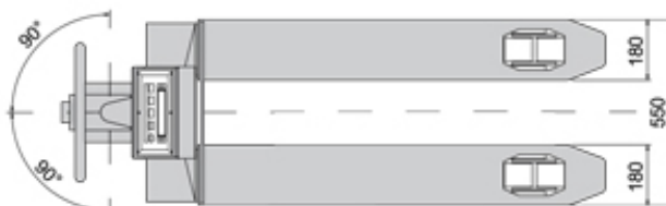
dimensioni in mm del transpallet pesatore
