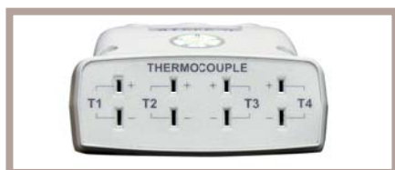
Ingressi per termocoppie
